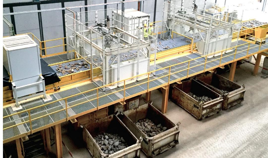
*Sortierband für vollautomatische Robotersortierung*
