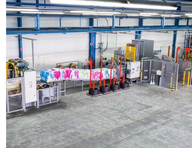
*Vollautomatische Press- und Wickelanlage*
